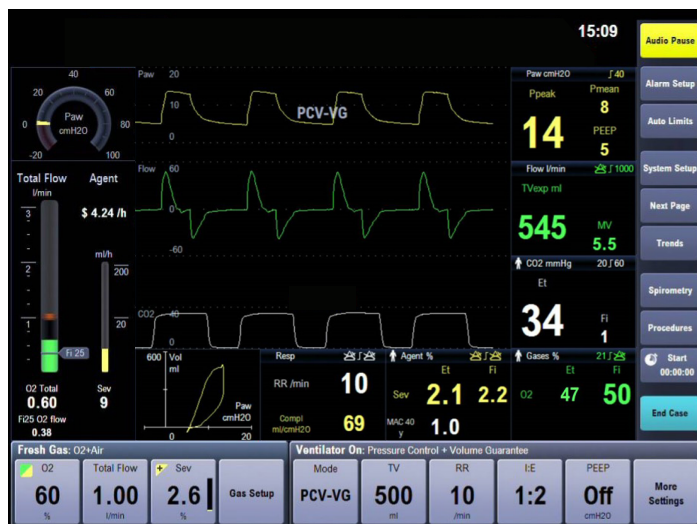
図 2. Aisys CS2 麻酔システムの ecoFLOW ディスプレイ。左下のパネルにフレッシュガスフロー設定が表示されます。FiO2 インジケータはトータルフローチューブ (緑色) で確認でき、麻酔剤コストは ml/h チューブ インジケータ (黄色) で確認できます。
